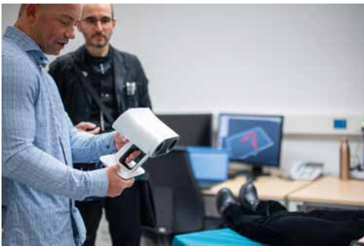
Abb. 1 und 2: Digitalisierung des Opfers mit einem mobilen 3D-Scanner
